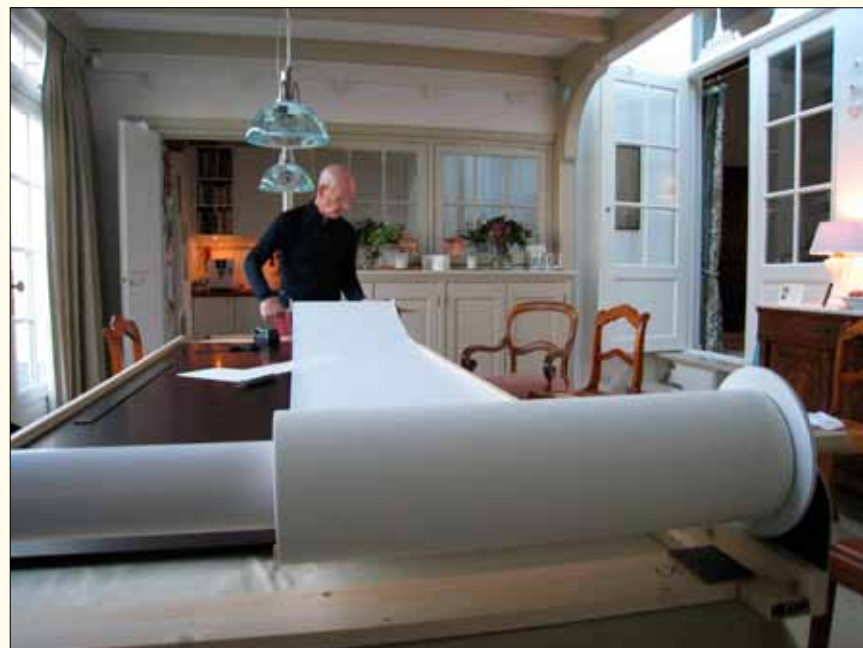
Met behulp van een zelfgebouwde snij-installatie en een stanleymes sneed Gijs Elzinga de rollen papier.
